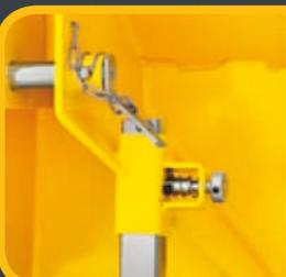
Dos alturas diferentes de acoplamiento al tractor que cuenta con la protección mediante el perno de seguridad (la pierna de soporte fijada).
