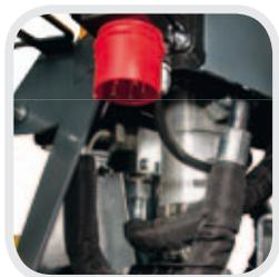
Bomba de engranaje dentado de dos etapas en los accionamientos eléctrico y con motor de gasolina asegura un consumo bajo de energía (en los modelos 23 y 27, en el modelo 18 **OPCIONAL**).
