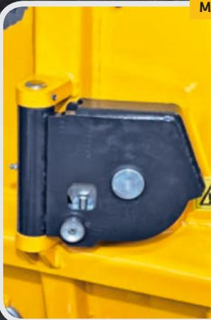
La polea inferior con imán y mecanismo que impide el desvío del cable de acero.
