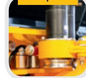
Desenrollador con dos rodillos impulsores y dos motores hidráulicos permite tensado mayor entre el cable y el desenrollador durante el desenrollamiento y asegura mayor potencia.
