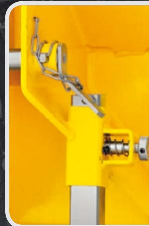
Dos alturas diferentes de acoplamiento al tractor que cuenta con la protección mediante pernos de seguridad (la pierna de soporte fijada).
