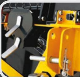
Montaje fácil y rápido del cabrestante al tractor. Después del trabajo el enganche se puede fijar en la carcasa del cabrestante.
