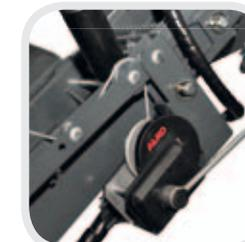
• Cabrestante mecánico para cambiar la inclinación de la cinta transportadora.
