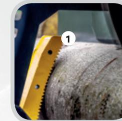
1. Palanca hidráulica estabiliza el tronco.
