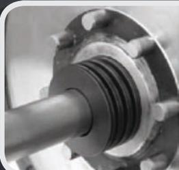
Resortes de platillo aseguran que podamos accionar y soltar el embrague con precisión.
