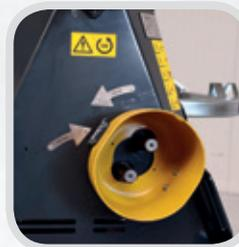
Acoplamiento en la parte delantera o trasera.
