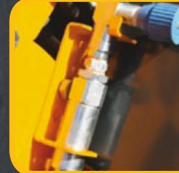
Válvula que asegura el tensado constante del cable de acero. Filtro de aceite de alta presión que impide la entrada de suciedad en el bloque hidráulico.
