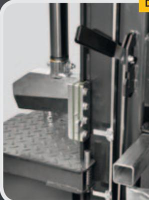
Desactivación automática del hacha: el dispositivo de desconexión en tres etapas impide daños en la mesa y el hacha.
