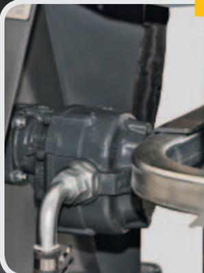
La bomba de acero fundido permite un funcionamiento silencioso de la rajadora y le otorga una larga vida útil.
