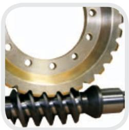
Accionamiento por medio del tornillo sin fin que posibilita gran relación de transmisión y permite cargas bruscas, y ruedas dentadas. El tornillo está hecho de acero de ley alta, mejorado, cementado y limado; la rueda está hecha de bronce especial, lo que le da más resistencia.
