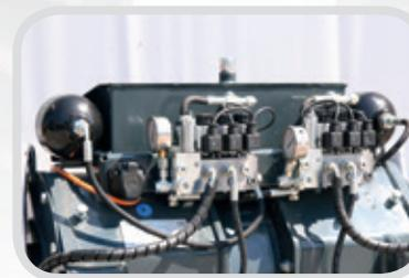
El bloque de control con válvulas de asiento y filtro de alta presión. Cabrestantes de dos tambores: Sistemas hidráulicos para tambores y el desenrollador del cable de acero independientes.
