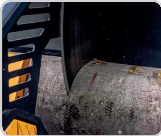
La sierra circular de disco con segmentos de carburo (vidia) corta el tronco en un tiempo récord debido a su resistencia a cuerpos extraños en la madera y a la forma de sus dientes.
