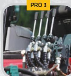
Manejo con las palancas de control. La válvula de flotador en la posición neutral para que se adapte automáticamente al terreno.
